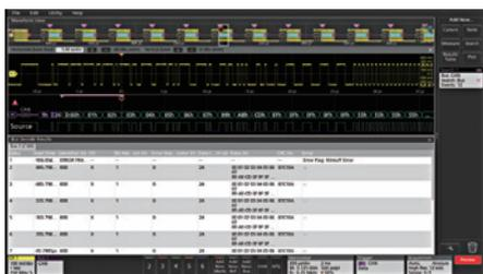
I<sup>2</sup>C、SPI、RS-232などのコンピュータ・バス、CAN、CAN FD、LIN、FlexRay、SENTなどの車載バス他、USBやEthernetなど、豊富なシリアル・バスに対応。プロトコル・デコード、サーチにより、シリアルバス解析が容易に。
